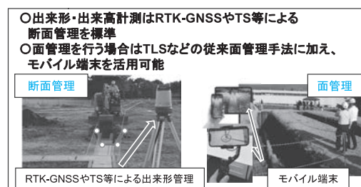
図-2 ICT 土工(小規模施工)・床掘工・小規模土工・法面工[新規]
