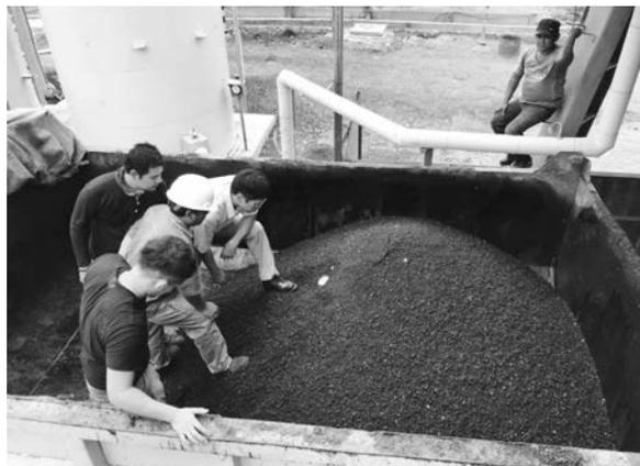
写真－8 リサイクルアスファルト混合物
