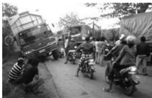
写真-4 オーバーレイ工法により生じた段差で脱輪した車両
