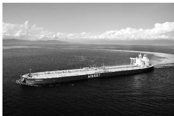
写真-2 船体用高延性鋼を採用した原油タンカー (VLCC)「BAGHDAD」(総トン数: 160,115 トン, 載貨重量: 310,000 トン, 正栄汽船株式会社提供)
