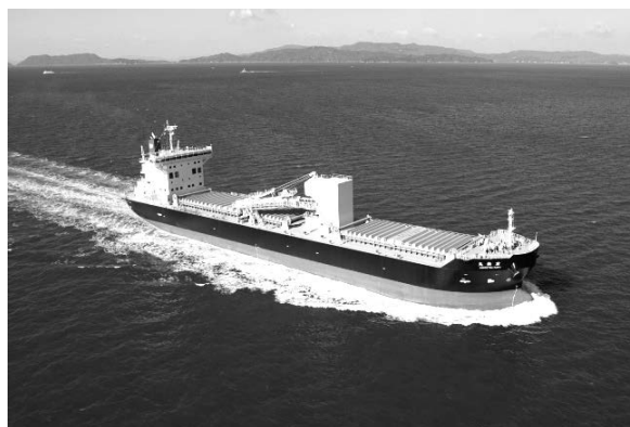
写真-4 船体用高延性鋼を採用した石灰石専用船「君鉄丸」(総トン数: 17,477 トン, 載貨重量トン数: 21,000 トン, 積載量: 20,000 トン, NS ユナイテッド内航海運株式会社提供, 共有船)
