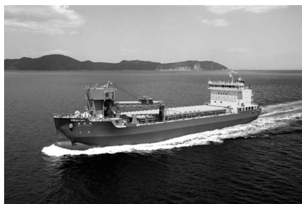
写真-3 船体用高延性鋼を採用した石灰石運搬船「名友丸」(総トン数: 5,589 トン, 載貨重量トン数: 7,500 トン, 三洋海運株式会社提供, 共有船)
