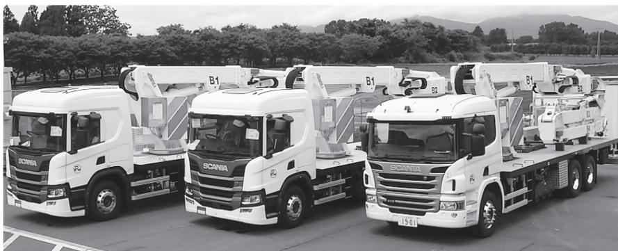
写真-1 ロードマルチ点検作業車
