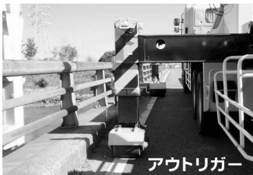
写真-4 アウトリガー構造
