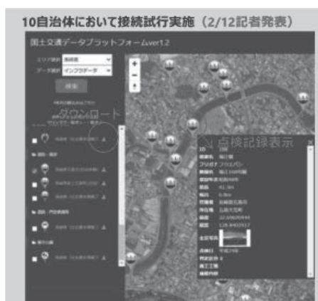
図－6 国土交通データプラットフォームと地方自治体データベースとの接続試行
