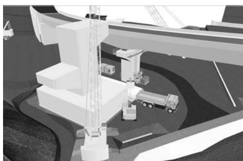
重機、仮設材の配置を事前に確認
