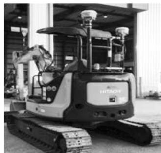
写真-2 ミニバックホウへのアンテナ取付
