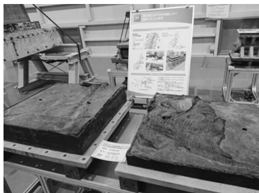
写真－9 破断ゴム支承
