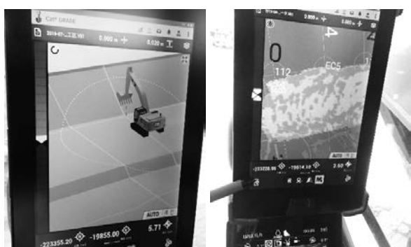
写真－５ ICT 建機の運転席モニター
