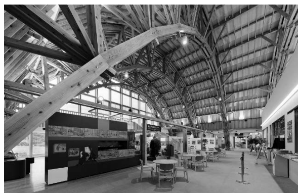
写真－3 定尺材アーチトラスによる大空間 (能代市 道の駅ふたつい)
