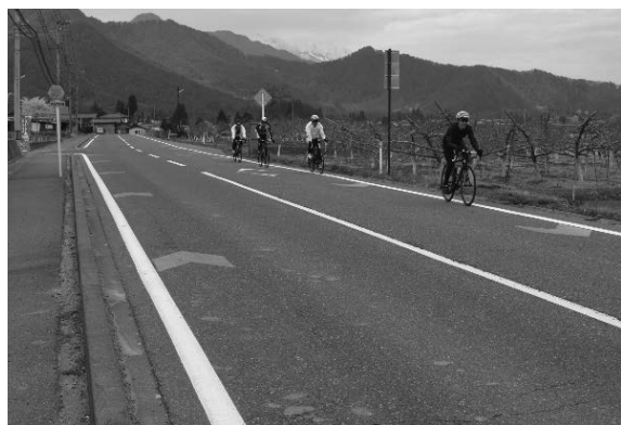
写真－1 矢羽根型路面標示
