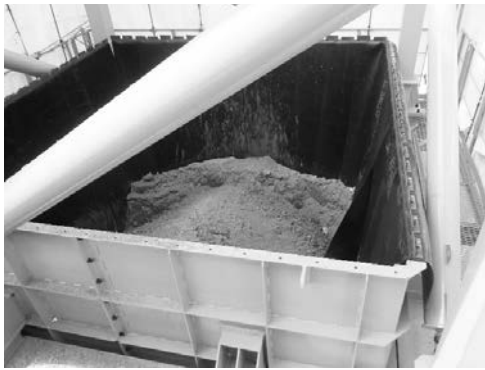
写真-12 ホッパー内ゴム板と外部防音シートによる騒音対策
