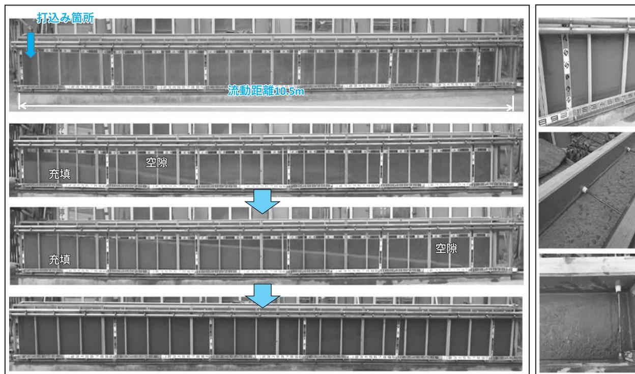
写真-12 流動試験の流動状況（上）と充填後の側面および上面の状態（右）
