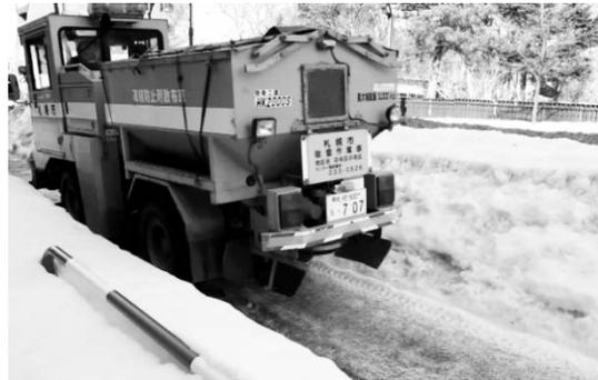
写真-1 滑り止め用砂の散布作業（歩道）
