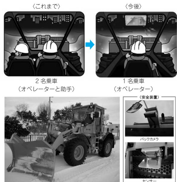
図-8 除雪機械（ショベル）の1人乗り化
