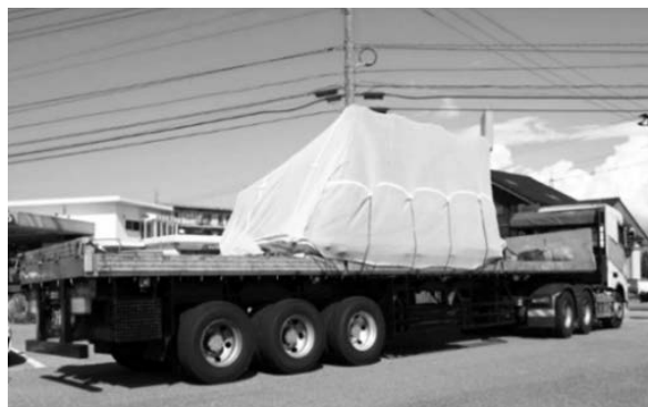
写真-1 河川用水門輸送状況
