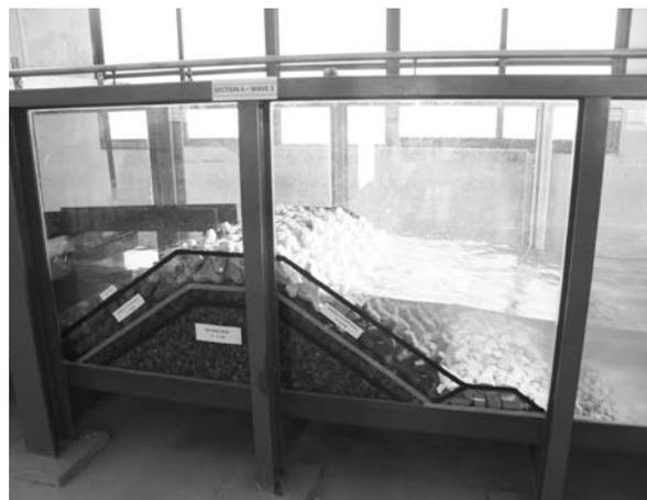
写真－1 ベトナム水資源大学での水理模型実験
