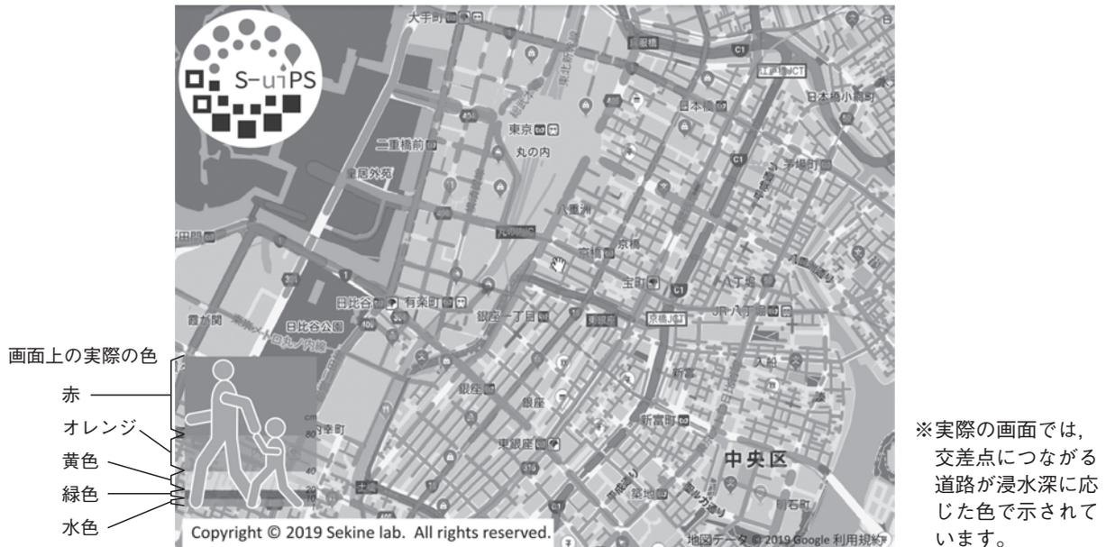
図-2 S-uiPSによる浸水情報の表示画面のサンプル
