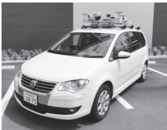
写真-1 移動計測車両（MMS 搭載）
