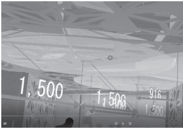
図-3 モデル化した感知器の感知区域と離隔距離
