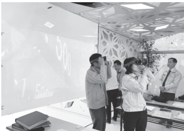
写真-1 感知器の感知区域や離隔距離を確認する様子（検査者が見ている MR 情報を現場内の大型ディスプレイにも表示）
