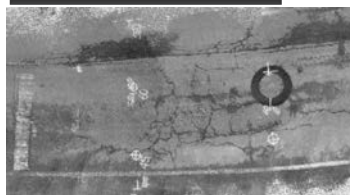
写真－4 路面クラック等の状態を可視化したオルソ画像
