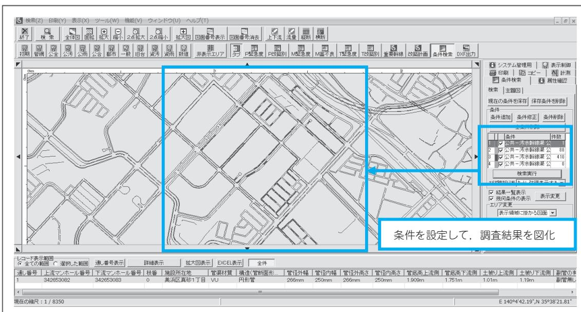
図-3 調査結果の見える化（管路台帳システム）
