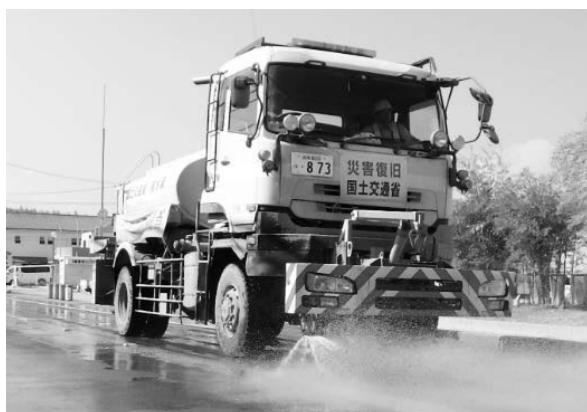
写真－10 散水車による防塵対策（岡山県倉敷市）
