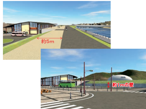
図-6 空間の幅は狭くなるもののキッチンカーなどの配置は可能であり壁高も目線程度
