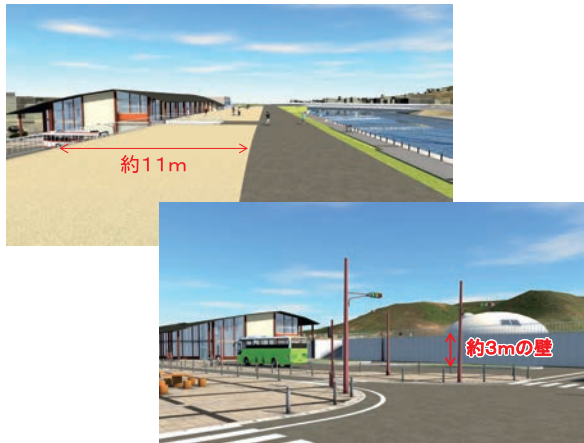
図-5 空間の幅を最大限確保しようとする壁高が3mとなり圧迫感が強い
