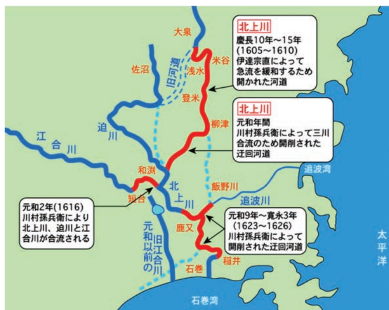
図－2 孫兵衛の行った北上川改修工事（北上川下流河川事務所提供）
