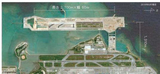
写真-4 那覇空港滑走路増設工事の状況
