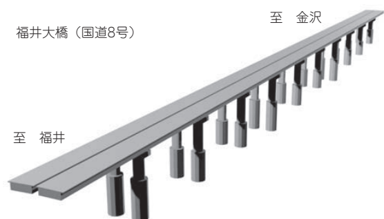
図-12 LOD200で3次元モデリングした橋梁
