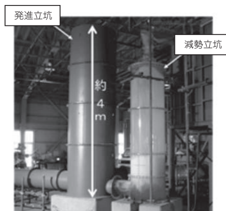
写真-2 水理模型実験の状況（ドロップシャフト型）
