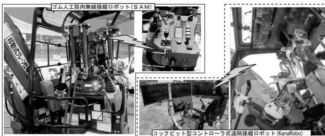
写真－4 ロボット型の遠隔操作装置
