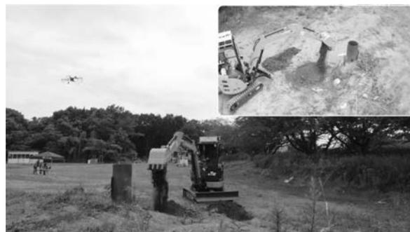
写真-1 無人建設機械に搭載した有線給電 MUAV の試験の様子
