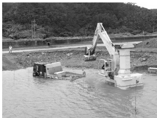
①水中バックホウとの連携作業による 半水中運搬実験
