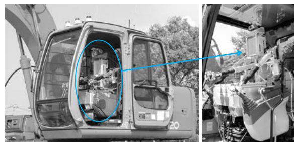
写真－2 簡易遠隔操縦装置（ロボQ）
