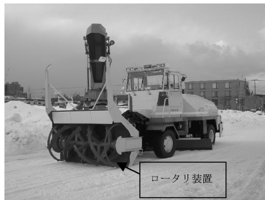
写真 3 スノーブラウ装着時(左) / ロータリ装置装着時(右)
