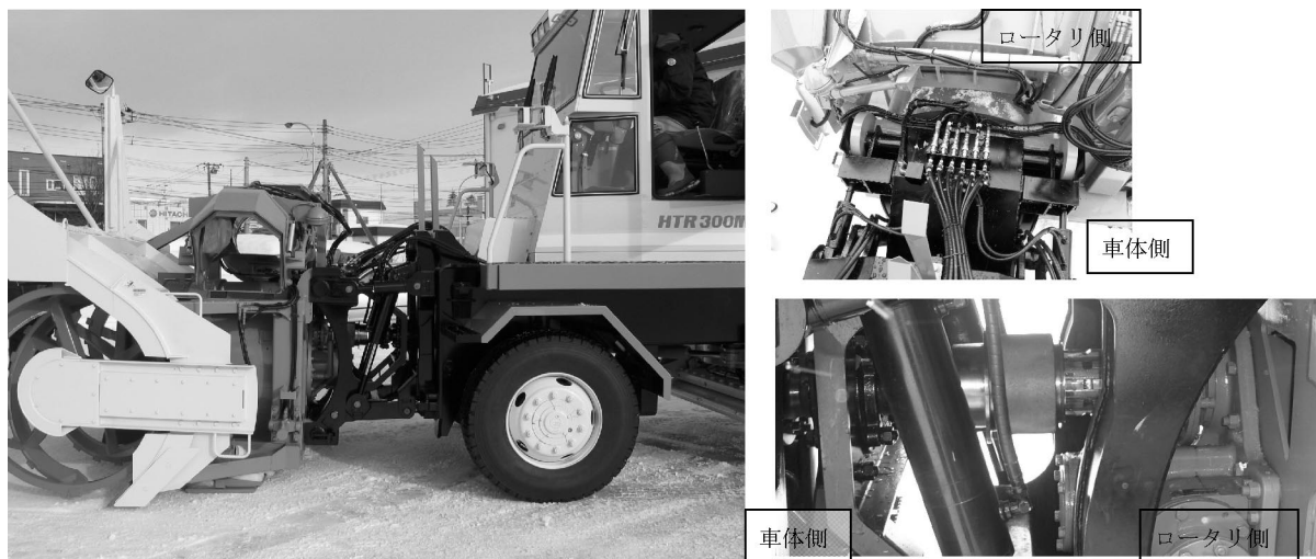
写真 4 ロータリ装置装着時(左) / 油圧ホース接続部(右上) / 駆動部接続フランジ(右下)
