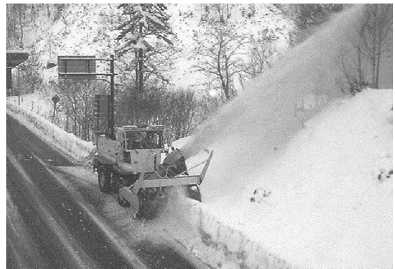
写真 2 ロータリ除雪車
