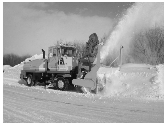
写真 5 路面整正作業(左) / ロータリ装置と路面整正装置の同時施工(右)
