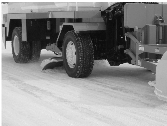
写真 5 路面整正作業(左) / ロータリ装置と路面整正装置の同時施工(右)
