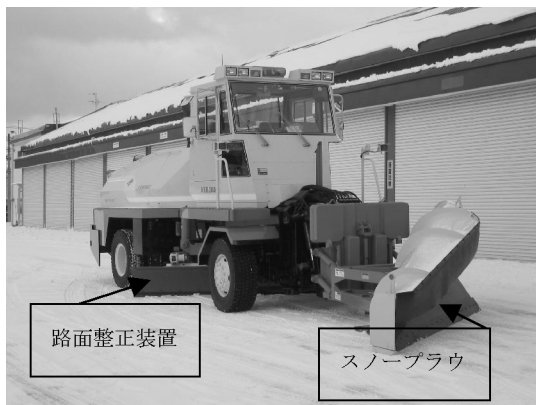
写真 3 スノーブラウ装着時(左) / ロータリ装置装着時(右)
