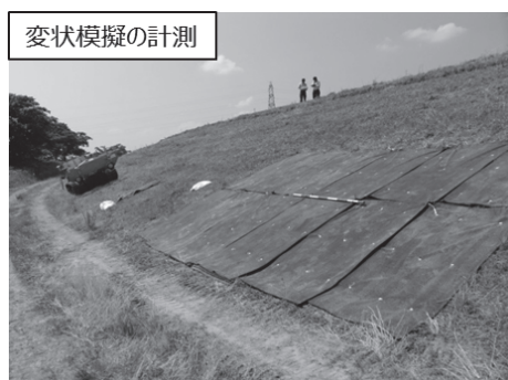
図－9 ゴムマットによるはらみだし模擬
