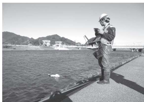
写真-1 自律走行無人ボートによる計測
