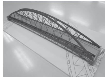
写真-6 3Dプリンターで作成した模型
