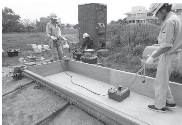
写真－2 鉄筋コンクリート対応型空洞調査用 GPR システムの供試体による検証状況
