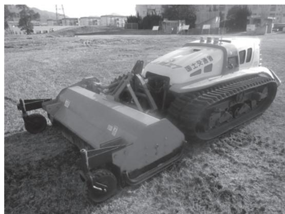
写真-1 大型遠隔操縦式草刈機
