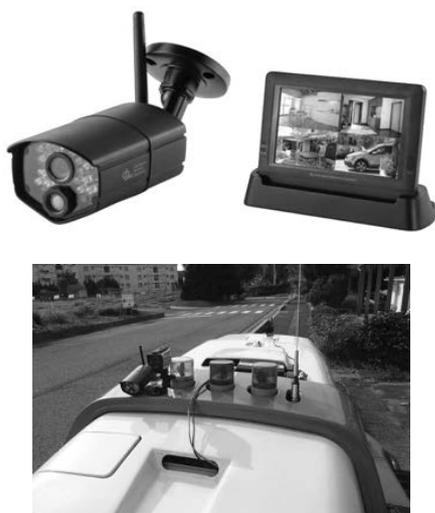
写真－18 ワイヤレスカメラのイメージと設置状況
