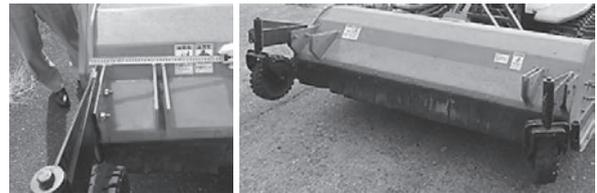
写真－12 標準仕様の車輪の取付位置
