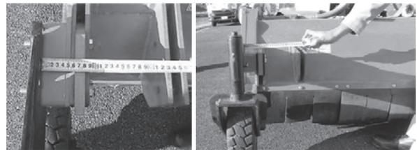
写真－13 変更後の車輪の取付位置
