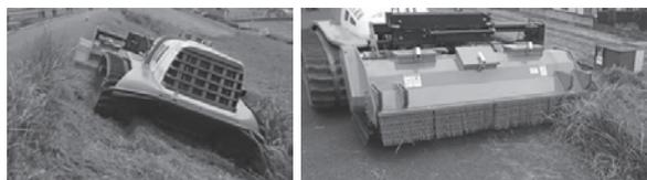
写真-17 スライド機能を使用した天端での除草状況
