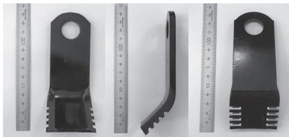
写真-5 刈刃の刃先の形状改良部品
