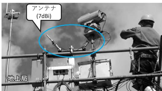
写真-3 地上に設置したアンテナ
