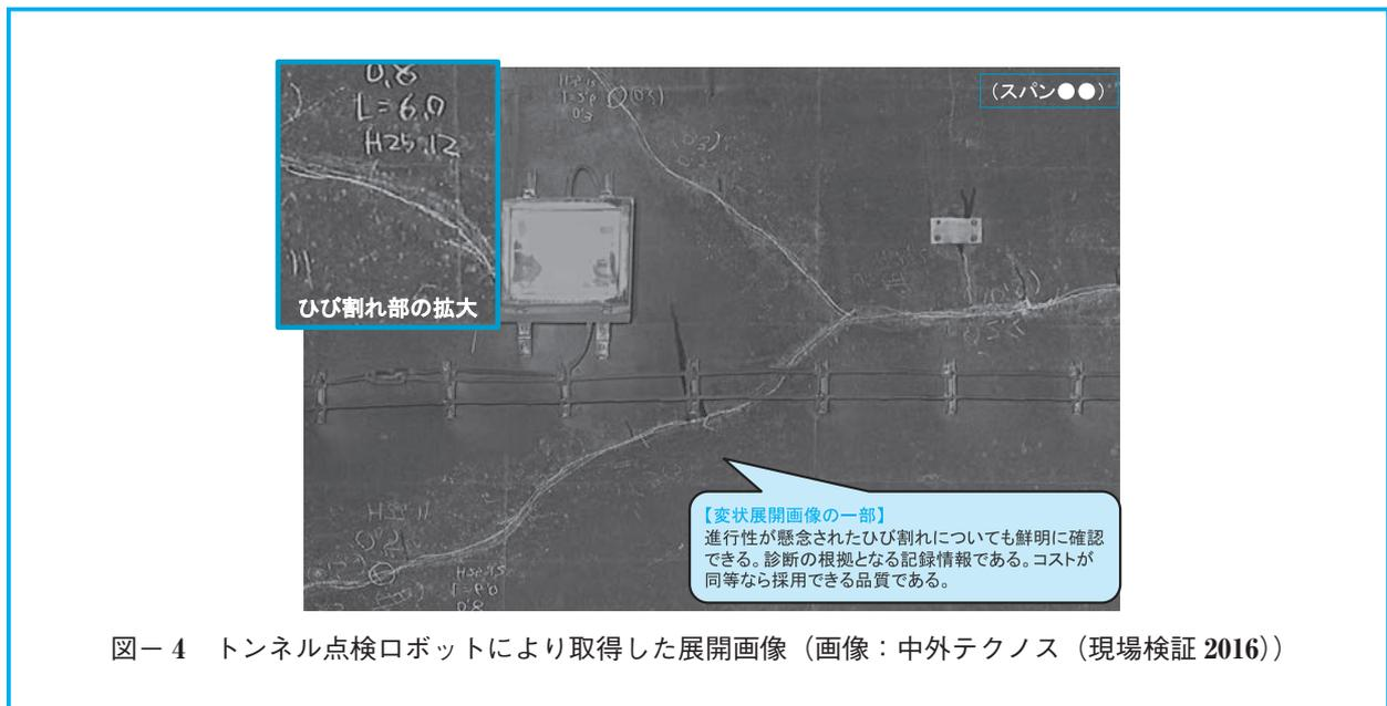
図一 4 トンネル点検ロボットにより取得した展開画像 (画像：中外テクノス (現場検証 2016))
