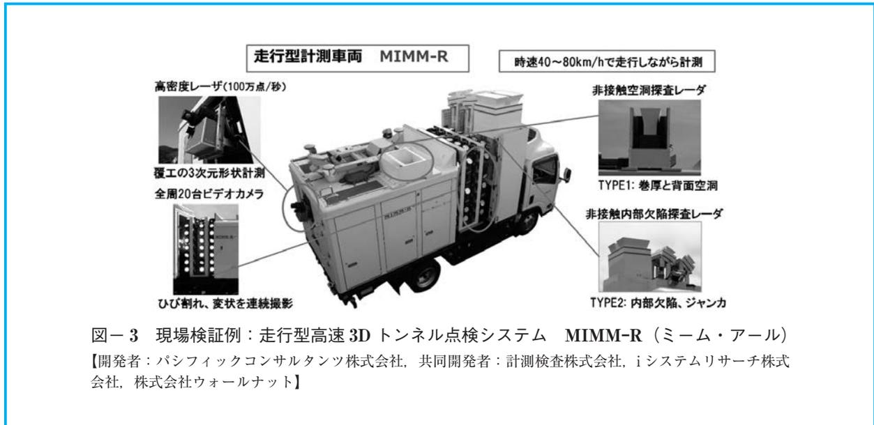
図一 3 現場検証例：走行型高速 3D トンネル点検システム MIMM-R (ミーム・アール)
