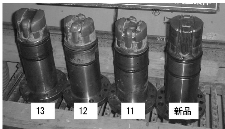
写真-3 リレービットの摩耗状況
