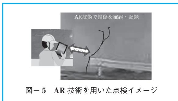
図-5 AR 技術を用いた点検イメージ
