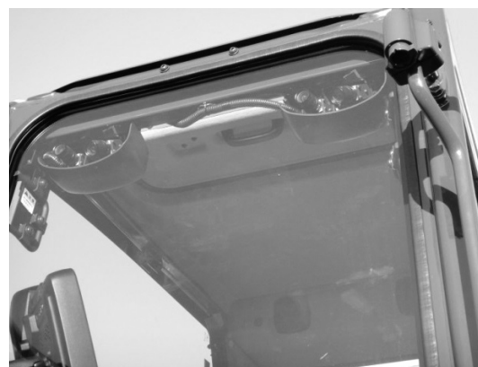
写真—2 ICT建機に搭載されたステレオカメラ
