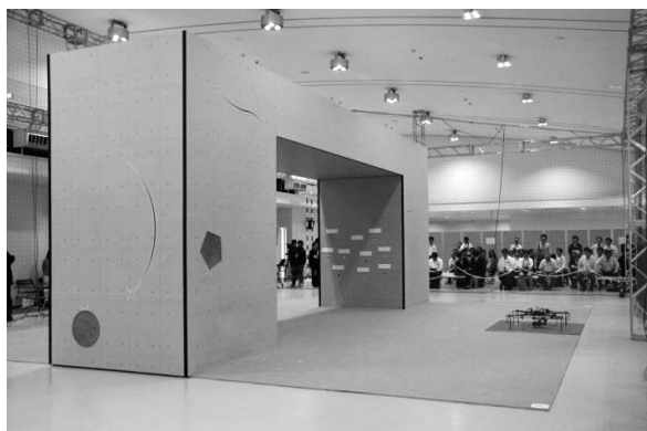
写真—2 橋脚を模した計測対象構造物
