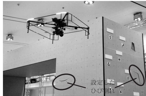
写真—4 ひび割れの計測状況
