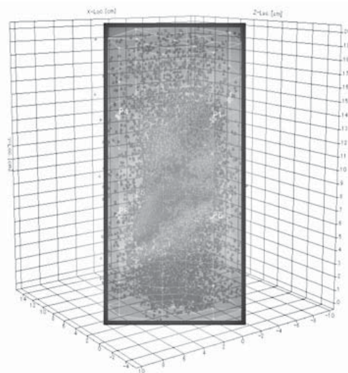
図ー３ 凝灰岩の三軸試験で得られたAE源と最終ステップで得られた一部のAE源のみでAEトモグラフィ解析した速度分布
