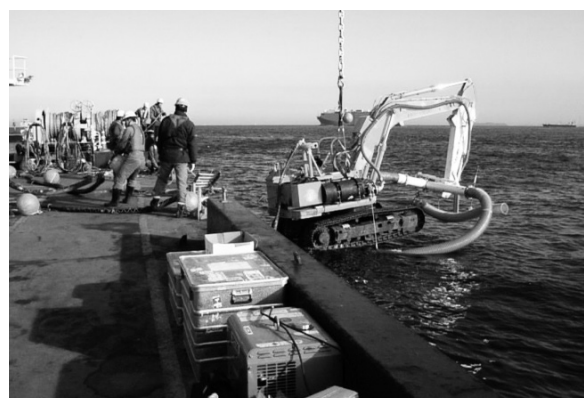
写真—2 水エジェクタを搭載した水中建機
