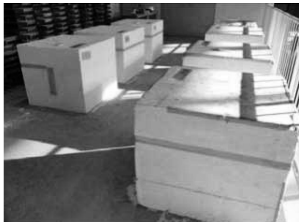
写真一 3 発泡スチロール製の容器を用いて簡易断熱養生を行った供試体
