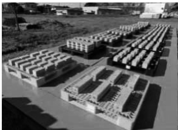
写真一 2 供試体の暴露状況
