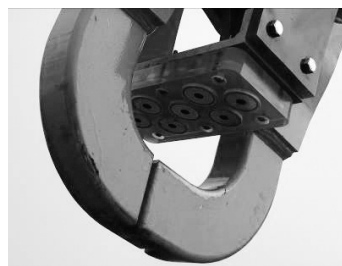
写真—9 フックと吊ひも引付け用磁石 （永久ネオジウム磁石）
