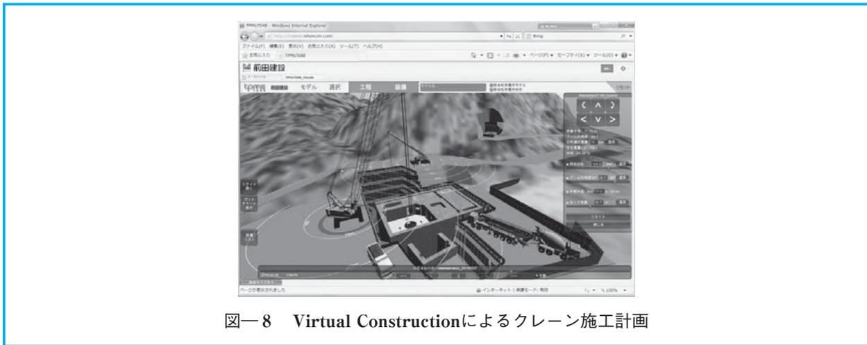
図一八 Virtual Constructionによるクレーン施工計画
