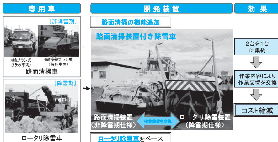
図－1 路面清掃車とロータリ除雪車の兼用化のスキーム図
