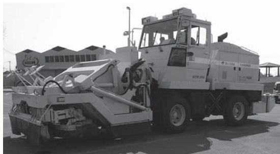
写真一 1 路面清掃仕様の外観
