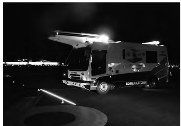
写真—2 定期点検の様子 路面性状調査
