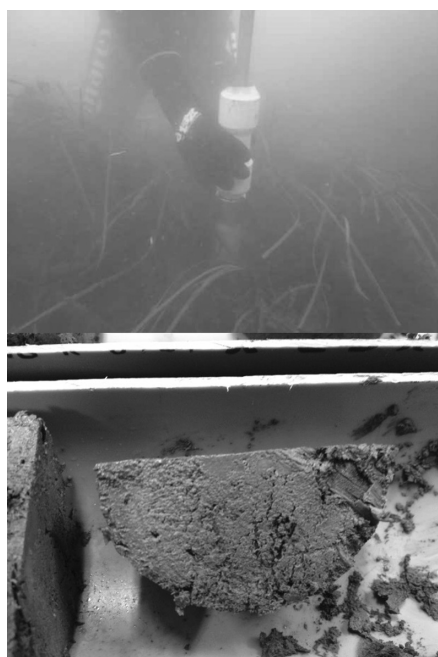
写真—1 堆積物コアの採取状況（上）とコア断面に見える数千年前の植物片（下）
